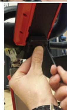
14. Conecte el adaptador del sensor de RPM al sensor de rpm utilizando el M3 x 6mm el tornillo de cabeza troncocónica de Philips.
