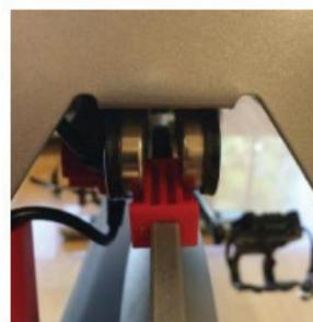
6. Gire la perilla del freno hacia la derecha hasta el freno de mecanismo haga contacto con la herramienta de calibración y oprime el botón de LUZ.
