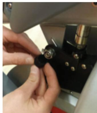
2. Deslice la funda en la tuerca hexagonal y asegúrese de que el maletero está en contacto con la placa negra del mecanismo de resistencia
