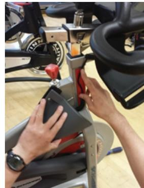
12. Enchufe el cable de consola CONECTOR RJ45 en la consola, a continuación, deslice el ojal del cable en la ranura de la tapa protectora del conector como se muestra.
