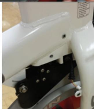
13. Desenrosque el M3 x 6 mm de cabeza alomada Philips el tornillo que sujeta la cubierta del sensor de RPM y retíralo.
