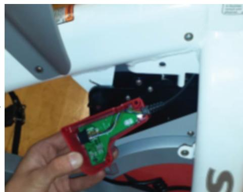
10. Fijar la sonda caso al mecanismo de resistencia utilizando el M4 x 6 mm de los tornillos con cabeza de botón. Utilice bloqueo de rosca azul en los tornillos para garantizar el sensor se monta completamente.
