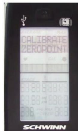
5. Siga la pantalla instrucciones; Coloque el herramienta de calibración en el volante, girar hacia atrás hasta la herramienta se ajusta entre los imanes del freno Asamblea y luego presione el botón de la luz.
