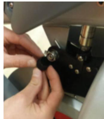
8. Deslice la funda en la tuerca hexagonal y asegúrese de que el maletero está en contacto con la placa negra del mecanismo de resistencia.
