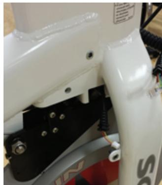
7. Monte el soporte de la consola usando los tres (3) M4 x 10mm tornillos de cabeza troncocónica de Philips, y apriete los tornillos
