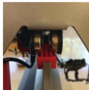
6. Gire la perilla del freno hacia la derecha hasta el freno de mecanismo hace contacto con la calibración la herramienta y pulse el botón luz.
