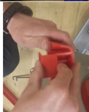
14. Enchufe el cable del sensor de RPM del conector de 2 clavijas en el conector del sensor de RPM y deslice el pasamuros de cable en la ranura de la caja del sensor de RPM.
