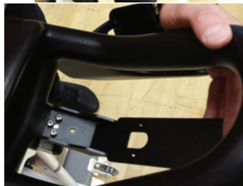
8. Deslice la consola sobre el soporte. Inserte el M3 x 6 mm y apriete el tornillo de cabeza plana con el destornillador.
