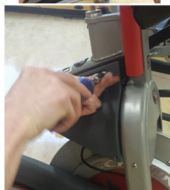
13. Coloque el tapón protector del soporte con los dos (2) M3 x 12mm tornillos Allen y apriete con la llave hexagonal de 2,5 mm.
