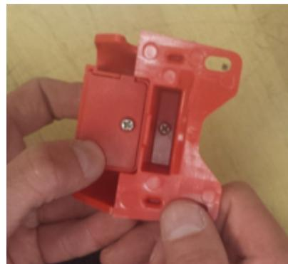
15. Desenrosque el M3 x 6 mm de cabeza alomada Philips el tornillo que sujeta la cubierta del sensor de RPM y retirarlo.
