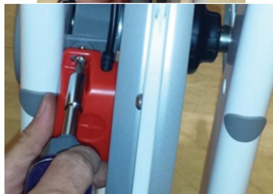
18. Vuelva a instalar el protector del sudor, a continuación, instale los dos montajes de silla de cable con los dos orificios en el interior de la horquilla izquierda mediante los dos remaches de plástico.
