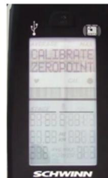
5. Siga las instrucciones en pantalla; coloque la herramienta de calibración en el volante motor, gire hacia atrás hasta que la herramienta encaja entre los imanes del conjunto del freno y, a continuación, pulse el botón de luz.
