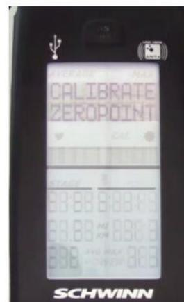
5. Siga las instrucciones en la pantalla instrucciones; Coloque el herramienta de calibración en el volante, girar hacia atrás hasta la herramienta se ajusta entre los imanes del freno asamblea y luego presione el botón de la luz.
