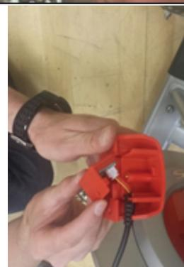
15. Reinstale la cubierta del sensor de RPM en el alojamiento, y reinstale el M3 x 6mm el tornillo de cabeza troncocónica de Philips.
