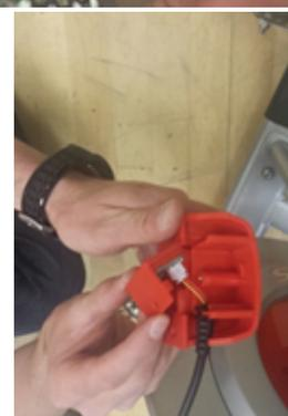
17. Reinstale la cubierta del sensor de RPM en el cárter, y reinstalar el M3 x 6mm el tornillo de cabeza troncocónica de Philips.
